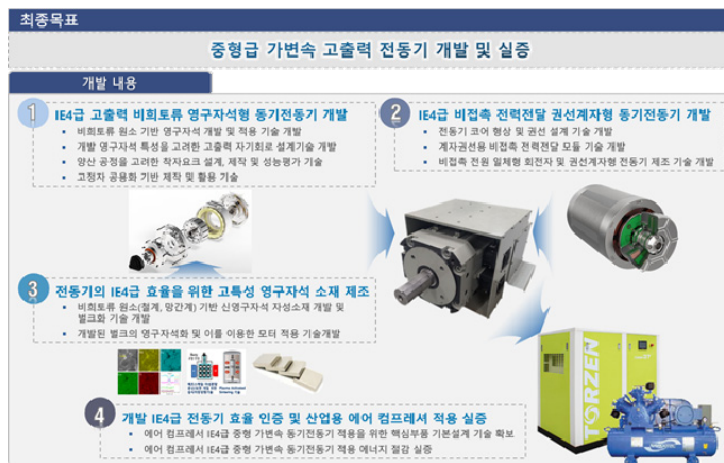
그림 1. 중형급 가변속 고출력 전동기 개발 및 실증 개요
